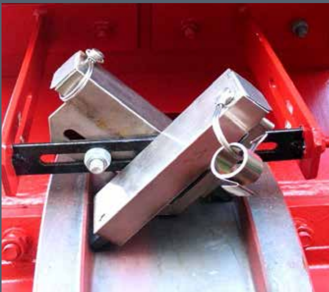
Spurkranzschmierung eines Bahnkranrads
